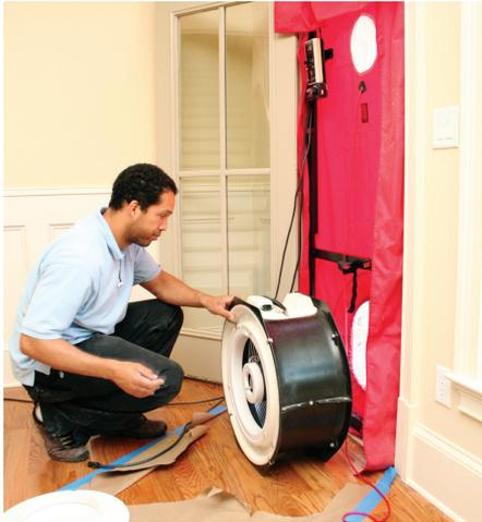
Configuración típica de la puerta del ventilador
